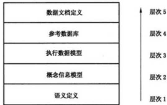
图 1 状态监测与诊断信息架构层次(引自 ISO 13374-2:2007)
